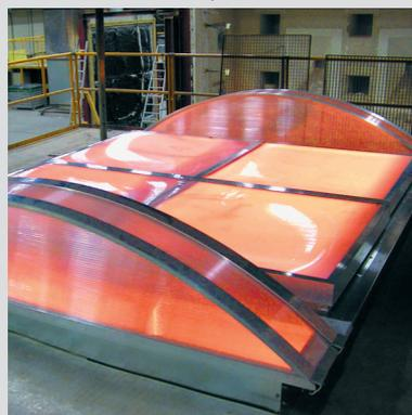
EuroMeteor при испытании на огнестойкость
